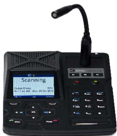
Console de bureau avec microphone col de cygne
